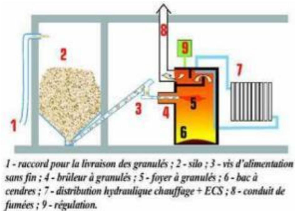
Figure 58 : Fonctionnement d'une chaudière décentralisée
